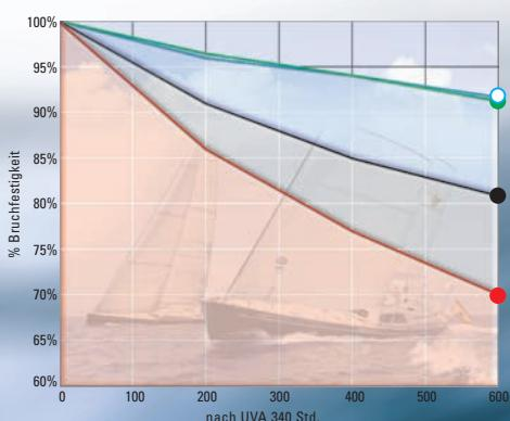
Die im D4® Prozess verwendeten Kleber enthalten UV-Schutz und anti-bakterielle Zusätze, um die maximale Lebensdauer Ihrer D4® Membran zu verlängern. Beschichtungen aus Titan-Dioxyd und anti-bakteriellen Additiven geben den Gewebeoberflächen (Taffetas) einen unvergleichbaren Schutz gegen UV und Stockflecken.
