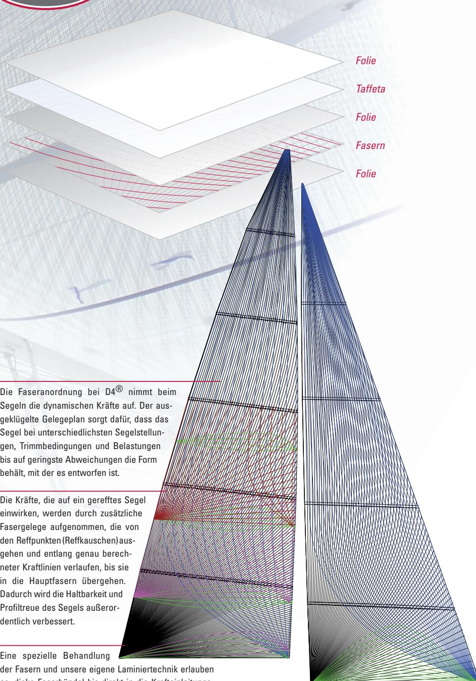
Die Faseranordnung bei D4® nimmt beim Segeln die dynamischen Kräfte auf. Der ausklügelte Gelegeplan sorgt dafür, dass das Segel bei unterschiedlichsten Segelstellungen, Trimmbedingungen und Belastungen bis auf geringste Abweichungen die Form behält, mit der es entworfen ist.
